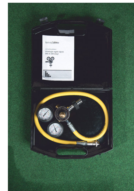
Hochdruck - Belüftungsventil High pressure ventilation valves
